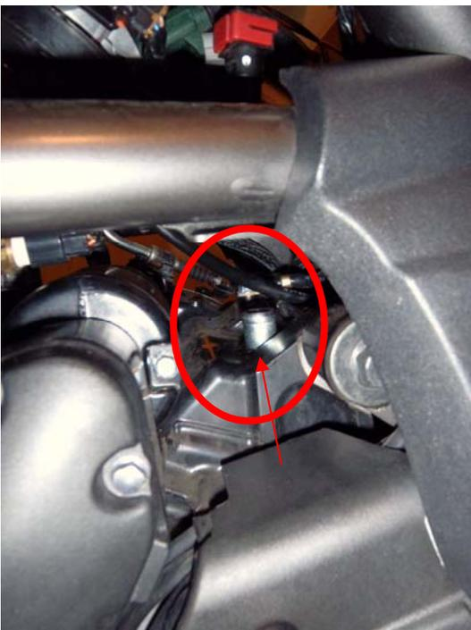
**Ecco il filtro acquistato, l'attacco ha diametro 12 mm.**
