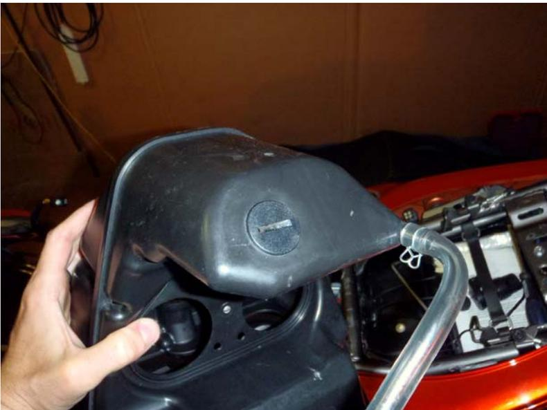
Per sicurezza ho anche messo della Pasta Nera per motori a sigillare il tutto ulteriormente!
