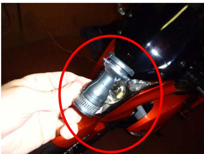
**Ora vi trovate la scatole del filtro con un bel buco da tappare! Potete usare qualsiasi cosa di gomma o plastica... evitate materiali ferrosi che scaldano parecchio di più!**
