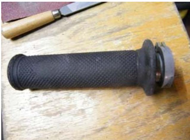
2. Procurarsi un tubo dello stesso diametro del giro interno (dove va a posizionarsi il filo) della manopola del gas:
